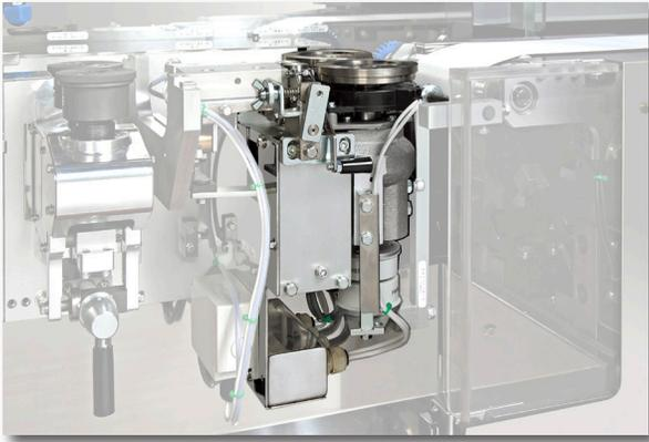
**AHORRO DE ENERGIA- CALENTAMIENTO POR INDUCCION** Tecnología de ahorro de energía, libre de mantenimiento, alcanzamos más rápidamente y de manera exacta la temperatura deseada.
